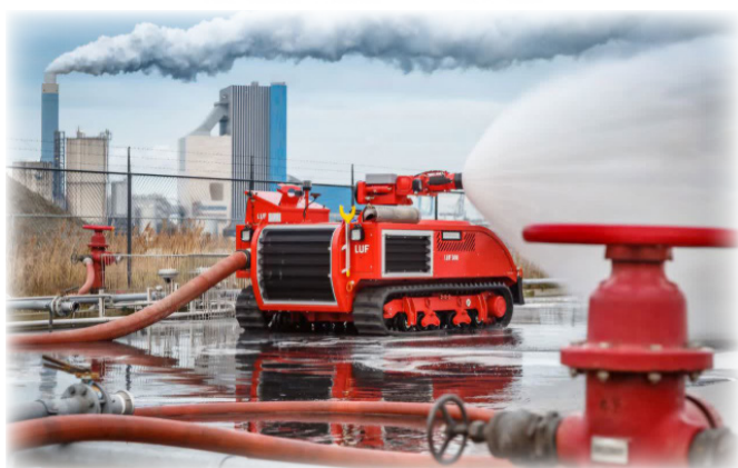
ربات شش چرخ مستقل مجهز به مانیتور 3 هزار لیتری ، دوربین الکترواپتیکال ، سنسور نشت گاز و ما و قابلیت پله روی و اعمال نیروی نیم تن
